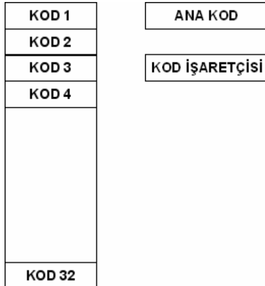
Şekil 2. Kumanda Hafızası Yapısı
